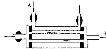
图 1 中空纤维膜反应器的结构
